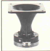
HTH 515: Druckkammer-Hochtöner mit sehr hohem Schalldruck und hoher Belastbarkeit, 80/100 Watt, 2 000 - 15 000 Hz, 8 Ohm, 110 x 110 mm
