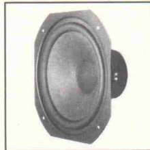
WS 26 SF: Ausgezeichnetes Tiefton-Chassis mit sehr hoher Belastbarkeit durch spezialbeschichtete Schwingpule, 150/200 Watt, 20 - 4 000 Hz, 8 Ohm, 264 x 264 mm
